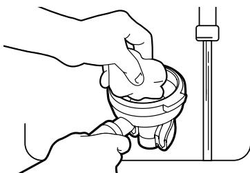
Detergi il portafiltro per rimuovere i residui grassi del caffè che influiscono negativamente sul gusto dell'espresso. Lava la parte esterna del tubo vapore/acqua calda con un panno umido e fai passare un po' di vapore nel tubo per eliminare tutti i residui interni di latte che potrebbero ostruire il passaggio del vapore rendendo più difficile montare la schiuma in maniera ottimale.
