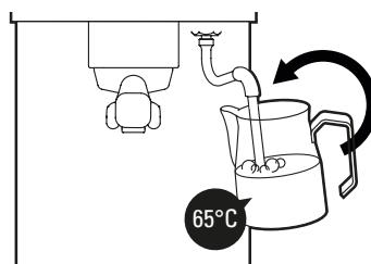
Scufundați tubul în lapte până la capăt și încărcați cană pentru a crea un vârtej. Încălziți laptele până la temperatura dorită fără a depăși 65°C. Închideți aburul. Prelucrați laptele obținut înainte, zbătând ușor cană de masă, pentru a elimina eventualele bule de aer, rotind-o apoi cu mișcări ample pentru a amesteca bine laptele și spuma. Trebuie să obțineți o suprafață netedă, cremoasă și fără bule.
