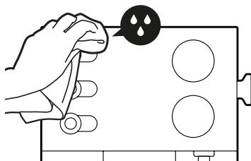
Verwenden Sie keine Scheuermittel und tauchen Sie die Maschine nicht ins Wasser. Für die sorgfältige Wartung empfehlen wir Ihnen die Bürste von Lelit (Code PL106, nicht enthalten), mit der Sie die Duschsieve und Zwischenräume zwischen den Dichtungen perfekt reinigen können, indem Sie alle Flecken und Rückstände von Kaffeepulver auch aus den schmalsten Ritzen entfernen können.
