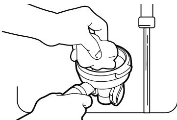
Ştergeți suportul de filtru pentru a îndepărta reziduurile grase de cafea, care influențează negativ gustul espressoului. Spălați partea exterană a tubului de abur cu o cârpă umedă și lăsați să iasă puțin abur din tub, pentru a elimina toate reziduurile interne de lapte, care pot obstrucționa trecerea aburului, făcând dificilă crearea spumei într-o manieră optimă.
