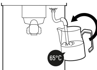
Опустите трубку еще ниже и наклоните питчер, чтобы создать вращение (воронку). Нагрейте молоко до требуемой температуры, не превышающей 65°C. Закройте подачу пара. Выполните обработку полученно-
